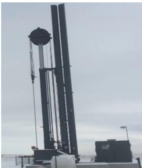
Figura 7: Unidade Hidráulica Acionada por Cabo.
