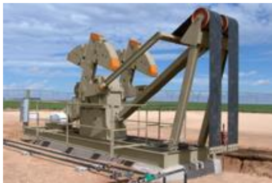
Figura 3: Unidade de Bombeio de Baixo Perfil.
