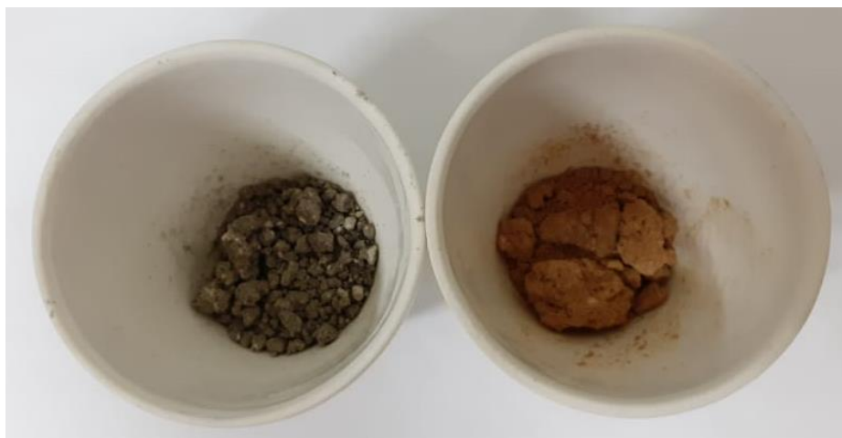
Figura 2: Cascalhos após secagem a 105 °C (esquerda) e tratamento em mufla (direita) a 600 °C
