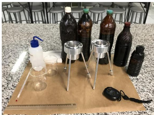
Figura 1: Materiais utilizados para determinação da viscosidade das amostras de petróleo utilizando o Copo Ford .
