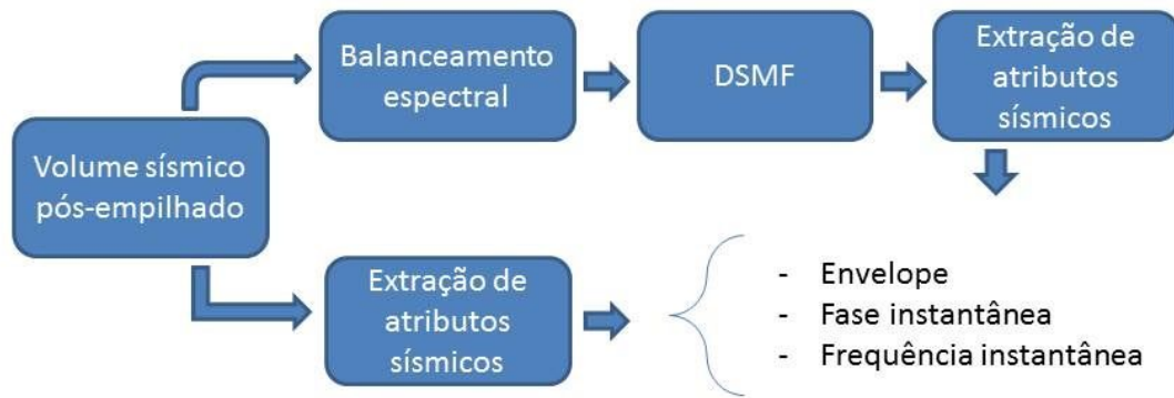
Figura 1 - Fluxograma para a obtenção dos atributos sísmicos com e sem tratamento do volume sísmico pós-empilhado.
