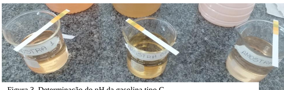
Figura 3. Determinação do pH da gasolina tipo C
