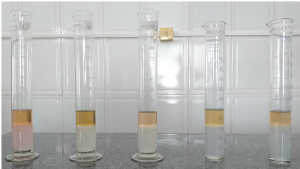
Figura 4. Determinação do volume da fase aquosa na gasolina tipo C
