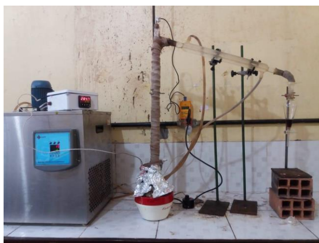
Figura 1 – Aparato experimental de destilação em escala de bancada
