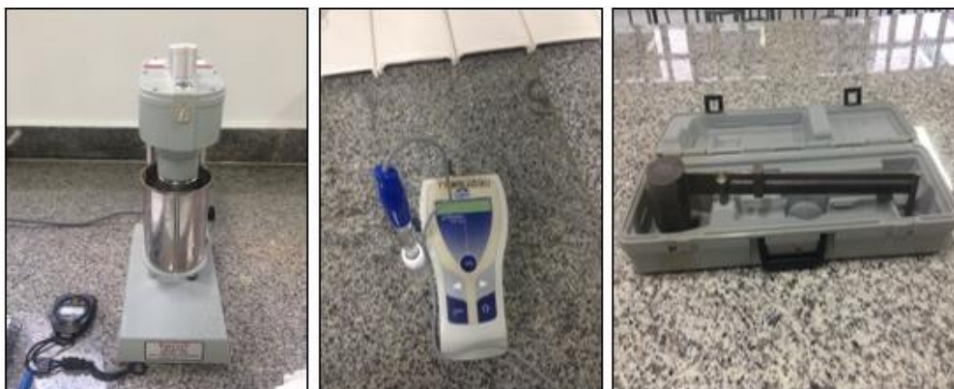
Figura 1: Equipamentos para as medidas das propriedades dos fluidos de perfuração Viscosímetro Fann 35 A, pHmetro e balança de lama 140 da Fann.
