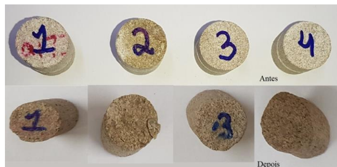
Figura 5. Amostras Calcário Jandaíra antes e depois do ataque ácido.
