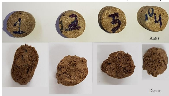
Figura 5. Amostras Calcário Jandaíra antes e depois do ataque ácido.
