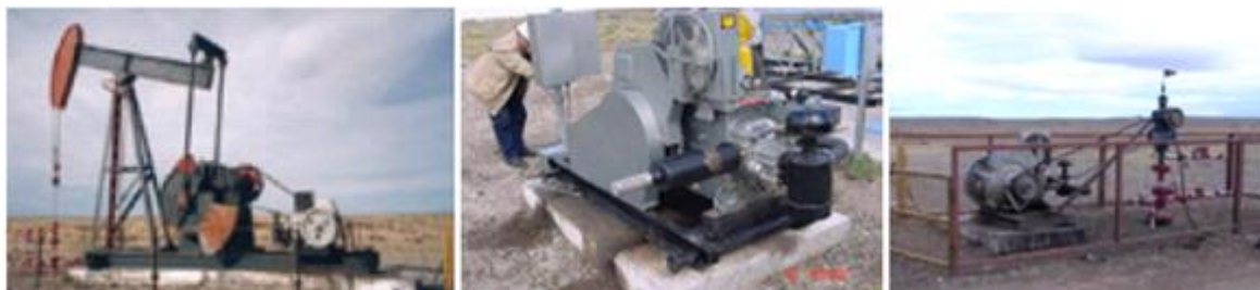
Figura 6 – Equipamentos movidos a gás natural bombeio mecânico (esquerda), bomba de injeção (centro) e bombeio de cavidade progressiva (direita) 9 .
