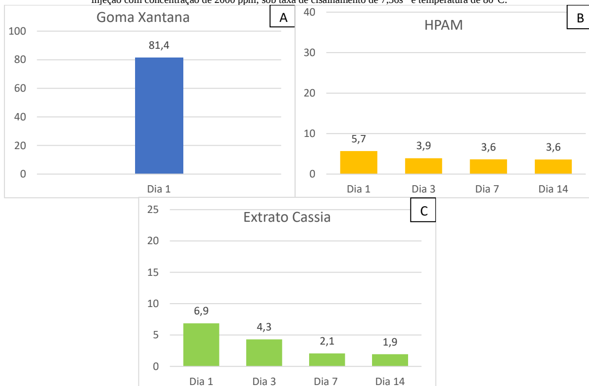
Figura 6. Influência do tempo e temperatura nas viscosidades das soluções de Goma Xantana, HPAM e extrato da Cassia em água de injeção com concentração de 2000 ppm, sob taxa de cisalhamento de 7,36s^{-1} e temperatura de 80^{\circ}C .
