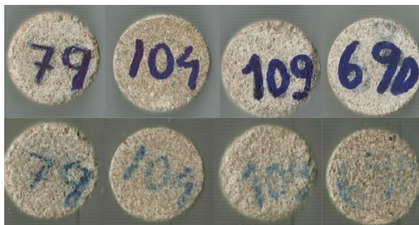
Figura 7 – Plugues de Indiana Limestone antes e depois da acidificação
