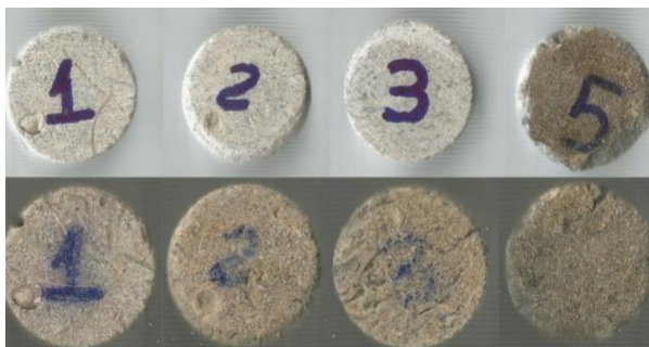
Figura 6 – Plugues de carbonato Pirabas antes e depois da acidificação
