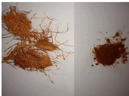
Figura 1 - Fibra do coco antes (à esquerda) e após (à direita) ser triturada no moinho de facas
