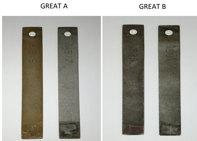
Figura 5. Aparência dos cupons - Branco (AA 916) e Dosagem 250 ppm (AA 917) para GREAT A e Branco (AA 923) e Dosagem 300 ppm (AA 931) para GREAT B.
