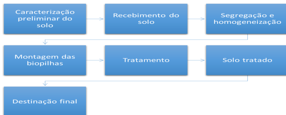
Fluxograma 1. Fluxograma do sistema de tratamento através de biopilha.
