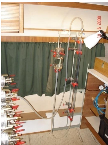
Figura 4: Detalhe do interior do laboratório móvel com a conexão entre os cilindros e a coluna de vidro para medida de gás.
