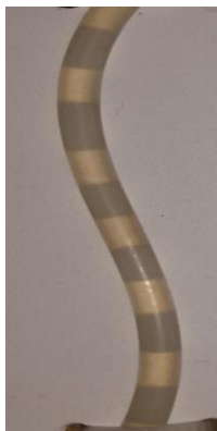
Figura 04 – Condição 2: Perfil de escoamento slug para vazão de 0,000105L/min
