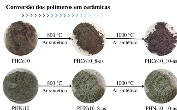
Figura 1. Registros fotográficos das amostras PHCo10 e PHNi10 antes e depois do processo térmico de conversão cerâmico em atmosfera de ar sintético a 800 e a 1000 °C.
