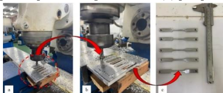
Figura 1 – Usinagem dos (a) corpos de prova da liga AA5083, (b) perspectiva ampliada e (c) resultado final.
