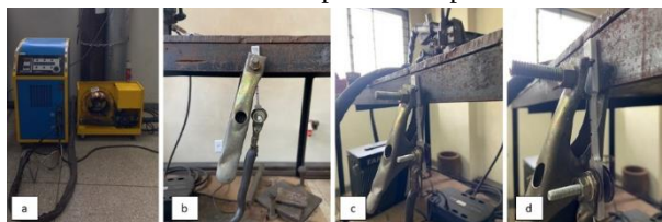
Figura 3 – (a) Máquina de soldagem Digiplus A7 600, (b) vista frontal do cp, (c) vista lateral do cp e (d) vista lateral ampliada do cp.
