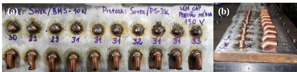
Figura 2 – Pinos M8 soldados na chapa de 12,7 mm de espessura após os testes de dobramento e de torque. (a) vista superior (b) vista lateral.
