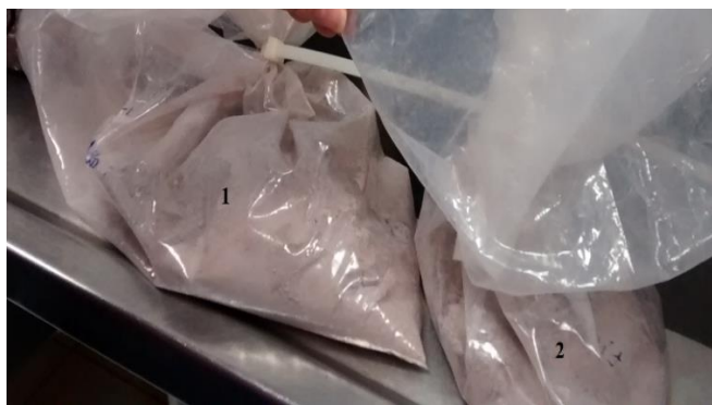
Figura 3. Aspecto dos pós oriundos da secagem dos fluidos
