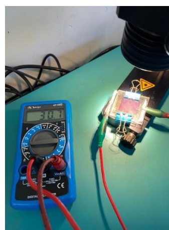
(b) Célula solar com iluminação solar simulada
