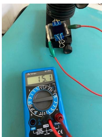
(a) Célula solar com iluminação ambiente
