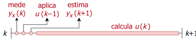
Figura 2 - Princípio de funcionamento do FCS-MPC.
