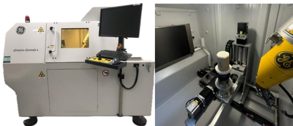
Figura 2: Microtomógrafo Phoenix v|tomex|s , ao lado está a preparação geral das amostras.
