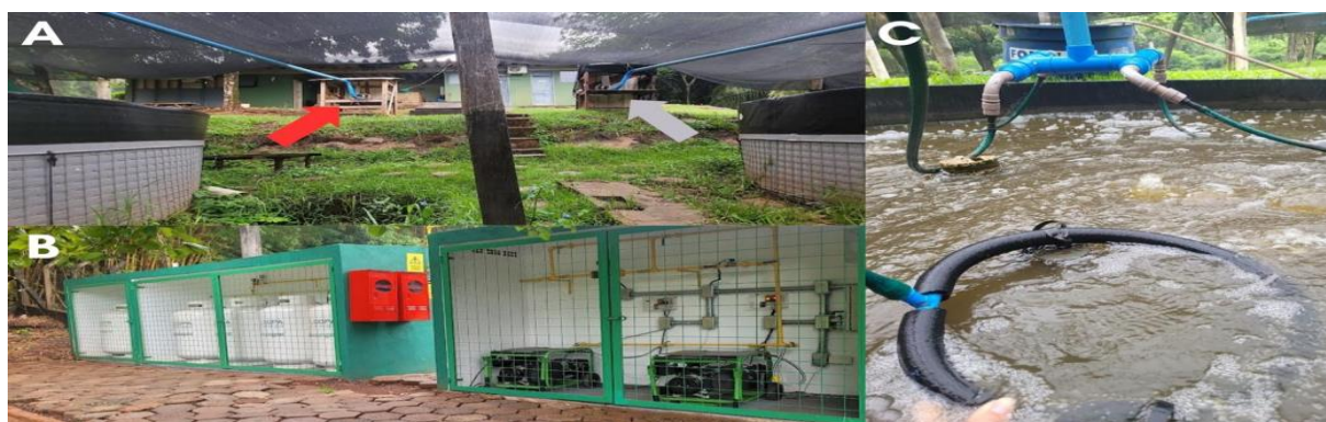
Figura 1: Detalhes da Unidade Experimental da Tecnologia BFT. (A) Tanques elevados de 4 m 3 de volume útil conectadas ao soprador (Compressor Radial) alimentados com GLP (seta vermelha) e a rede elétrica (seta cinza); (B) Cilindros de GLP, geradores movidos a GLP (interligados); (C) Detalhes das mangueiras porosas (onde o oxigênio é direcionado aos tanques).
