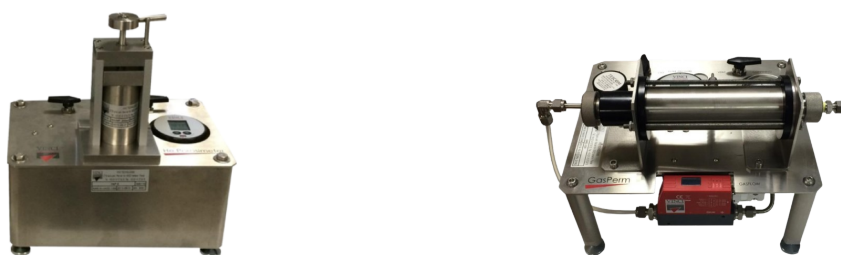
Figura 2 – Porosímetro Educacional a gás Hélio (lado esquerdo); Permeabilímetro a gás – GPE – 100 (lado direito)
