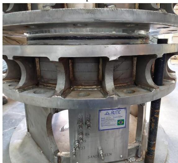
Figura 5: Base da célula radial com as conexões para encaixe das sondas dos transdutores de pressão.
