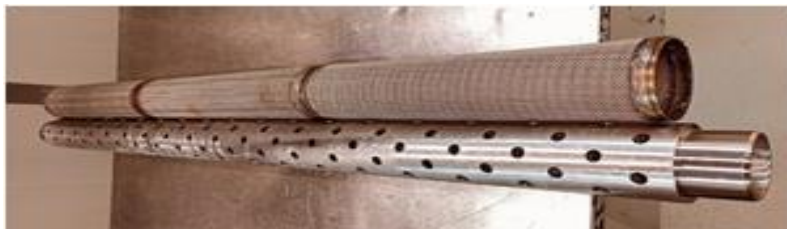
Figura 4: Tela de areia fabricada pelo CNPEM.
