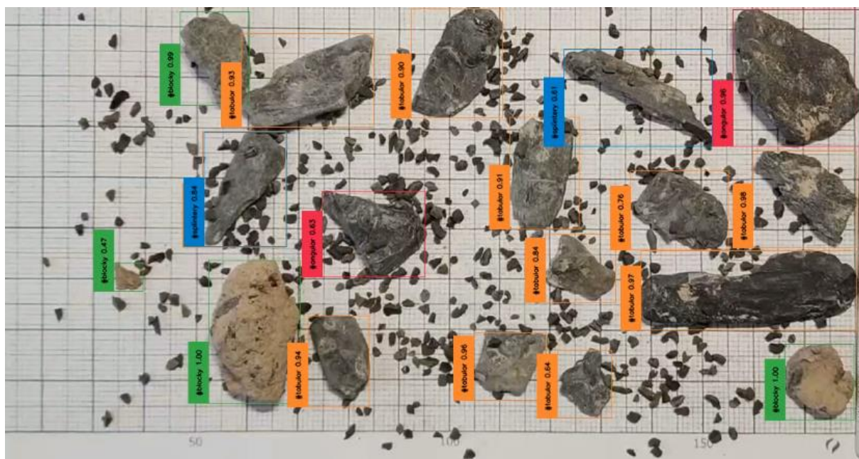
Figura 4 - Predição dos tipos de folhelho em amostra de calha através do modelo de visão computacional YOLOv8. Para cada fragmento, as labels contam com o nome da classe correspondente e o nível de certeza (variando de 0 a 1) que o modelo teve para classificar cada fragmento. Laranja: tabular; verde: blocky; azul: splintery; e vermelho: angular. Por motivos de simplificação, foi desabilitada a exibição das labels relacionadas aos fragmentos de menor tamanho (cuttings).
