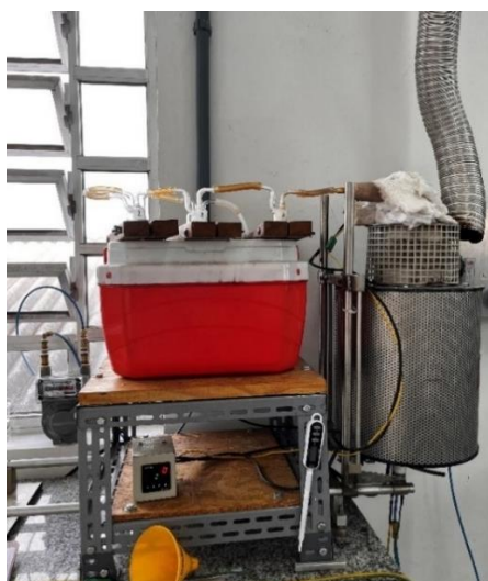
Figura 1 – Sistema construído para coleta de bio-óleo durante as pirólises de engaço de uva bruto e torreficado.
