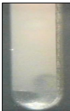
Figura 4 - Imagem do sistema com 86,53% de CO 2 entre 56,565 e 61,384 MPa em que não houve separação de fases na transição LL superior
