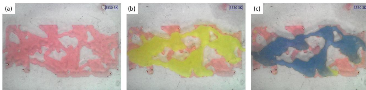
Figura 2 - (a) injeção do óleo modelo; (b) injeção de salmoura; (c) injeção do fluido polimérico sem carga.
