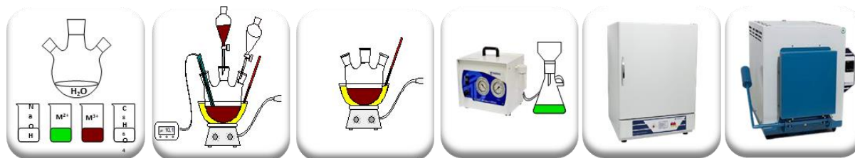
Figura 1. Método de obtenção dos catalisadores de tipo óxido misto a partir de hidróxidos duplos lamelares.
