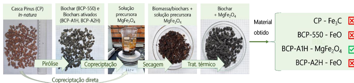
Figura 01 – Esquema representativo do método de síntese desenvolvido e descrição dos materiais obtidos.
