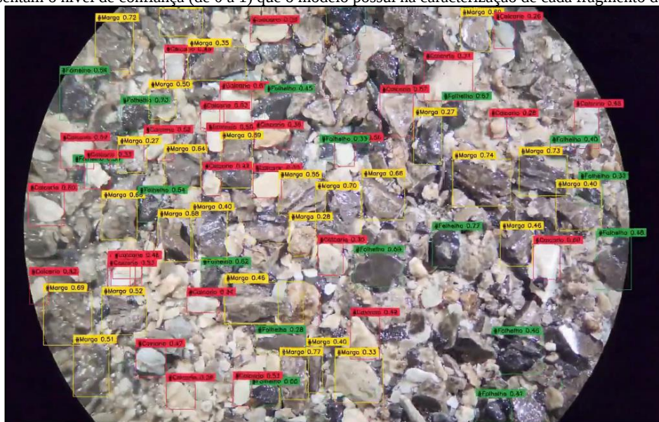
Imagem 3: Frame do vídeo de teste das amostras de calha após aplicação no modelo de visão computacional YOLOv8 utilizado neste trabalho. Em vermelho: calcário; verde: folhelho, amarelo: margas. Detalhe: os números em cada label representam o nível de confiança (de 0 a 1) que o modelo possui na caracterização de cada fragmento de rocha.
