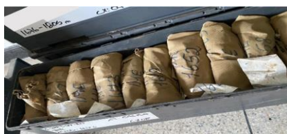
Figura 1 - Amostras de cascalhos acondicionadas em sacos de pano com indicação da profundidade.
