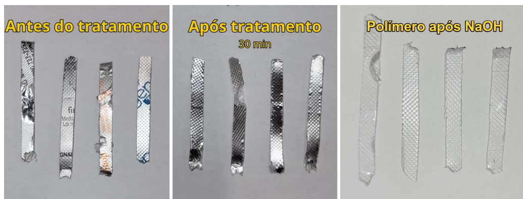
Figura 3: Blisters após cada etapa do processo. Da esquerda para a direita: fragmentação, tratamento em ácido fórmico, degradação do alumínio em NaOH.
