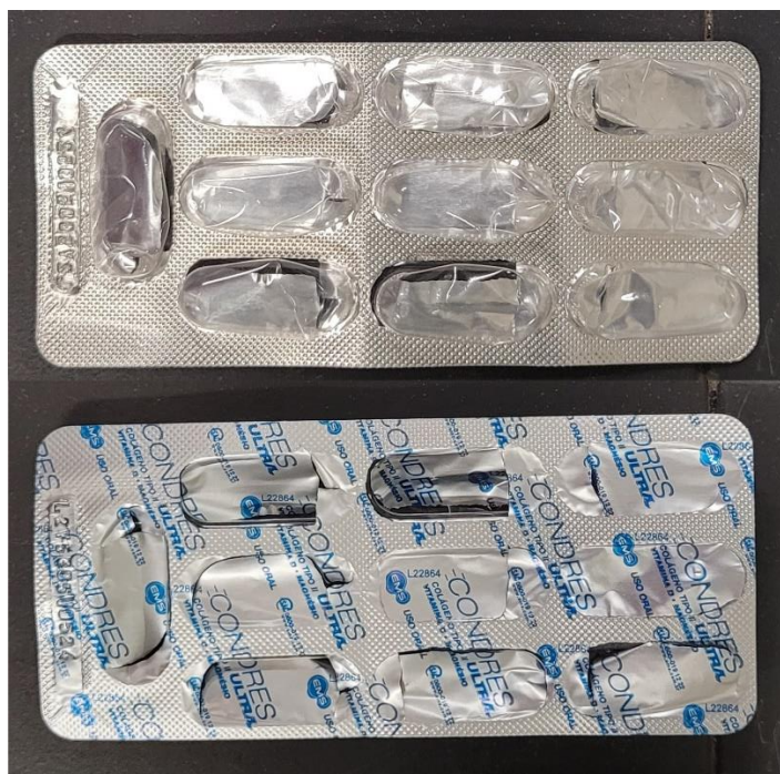
Figura 1 – Embalagem blister utilizada neste trabalho, com camada de polímero transparente e metálica.
