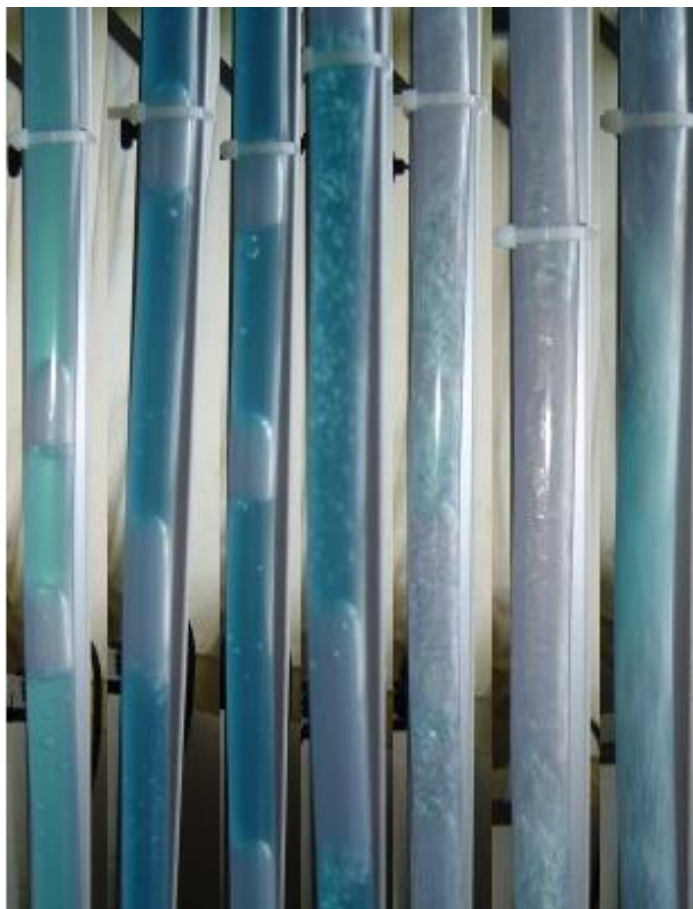
Figura 7 - Regimes de escoamento no tubo de produção do Micro-Poço Experimental
