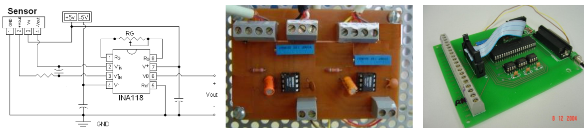
Figura 4: Esquema do Circuito de Amplificação, Placa com o Circuito Implementado e placa Mônica
