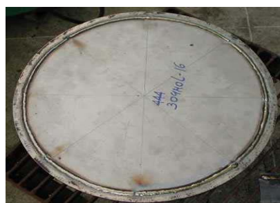
Figura 3. Desenho esquemático do corpo de prova em que foram realizados ensaios de Fadiga Térmica.
