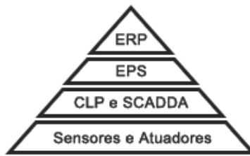
Figura 1 –Modelo em camadas de um Sistema de Automação.
