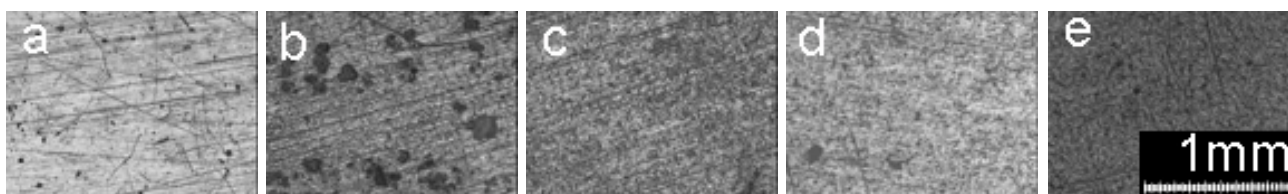
Figura 3. Evolução morfológica da superfície das amostras de poliamida 6: a) não envelhecida, b) 8 dias, c) 9 dias d) 14 dias e e) 18 dias. Aumento de 50 vezes.
