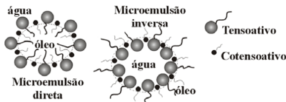
Figura 2. Estrutura de microemulsão O/A e A/O.
