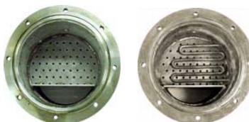
Figura 1. Vista superior do módulo com detalhamento do prato sem e com resistência elétrica.
