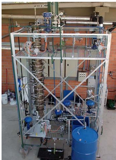
Figura 2. Ilustração geral da unidade piloto de destilação.
