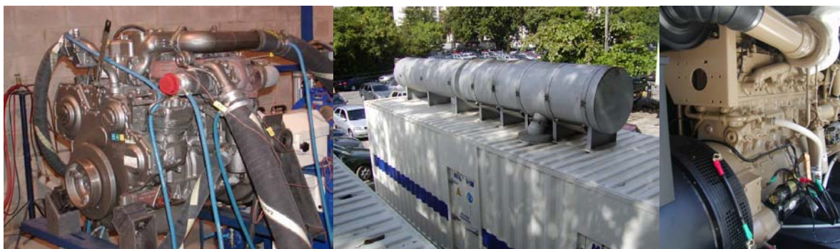
Figura 2 – Motor em teste de laboratório (esquerda) e geradores Diesel convertidos para o consumo do gás na PUC-Rio (1.2MW e 360kW, centro e direita respectivamente)
