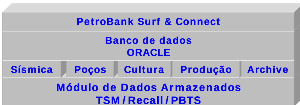
Figura 11. Estrutura de Bancos de Dados
