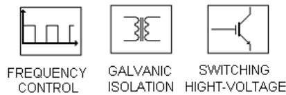
Figura 6. Diagrama de blocos do Circuito de Chaveamento
