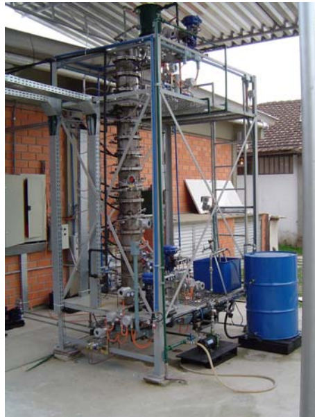
Figura 3. Unidade experimental de coluna de destilação do PRH34-ANP
