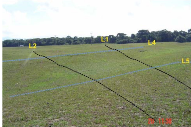
Figura II: Foto mostrando as linhas de aquisição dos dados. Notar que as linhas L1 e L2 são transversais às cristas dos cordões litorâneos e as linhas L4 e L5 são paralelas às cristas (a linha L3, que não aparece na foto é paralela às linhas L1 e L2)
