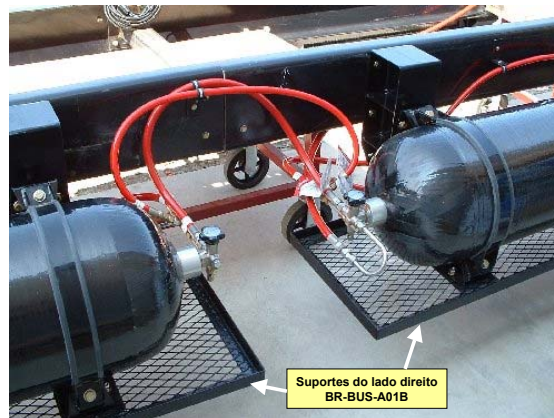
Figura 2. Vista geral do cilindro DYNETEK – V 176 utilizados para armazenagem de GNV.
