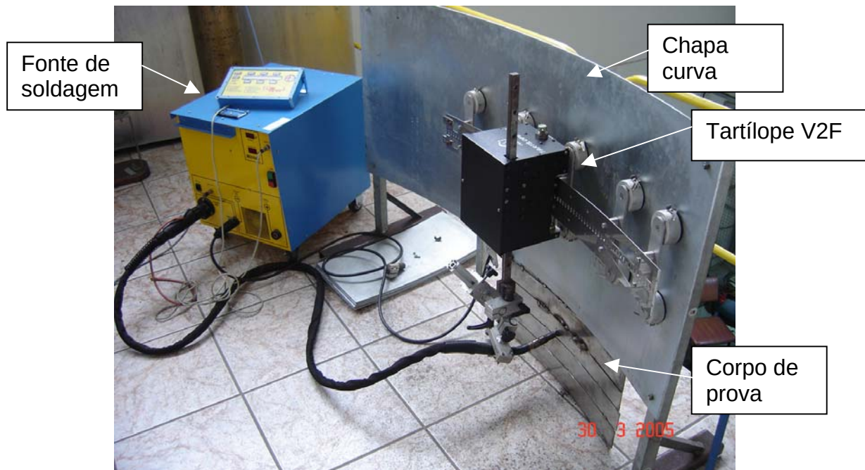
Figura 5: Fotos do Tartílope V2F montado na bancada de ensaios para o desenvolvimento dos procedimentos para a soldagem em revestimentos do tipo Lining.
