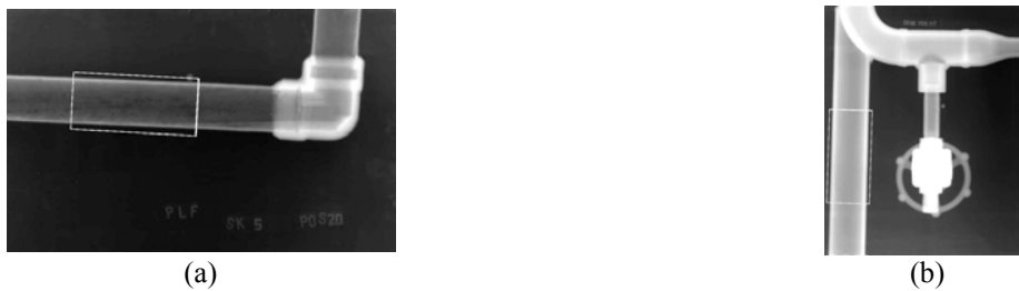
Figura 4. (a) Imagem radiográfica de tubos com corrosão. (b) Imagem radiográfica de tubos em bom estado.
